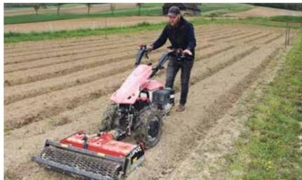
Für die Standardbeetbreite von 80 cm gibt es eine Fülle von Anbaugeräten wie Mulcher, Fräse oder die abgebildete Kreislegege.
